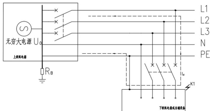
图 2 TN-S 系统接地故障示意图
