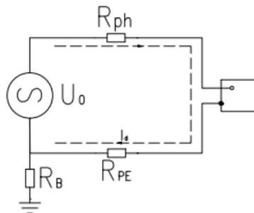
图 3 TN-S 系统接地故障等效电路图 (忽略回路电抗 X)
