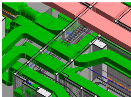
图 3 风管与桥架碰撞
