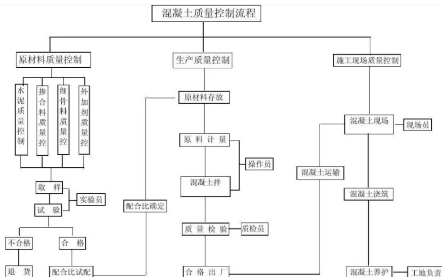
图1 混凝土施工质量管控流程图
