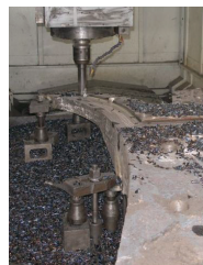
图3 铸钢构件表面机加工照片
